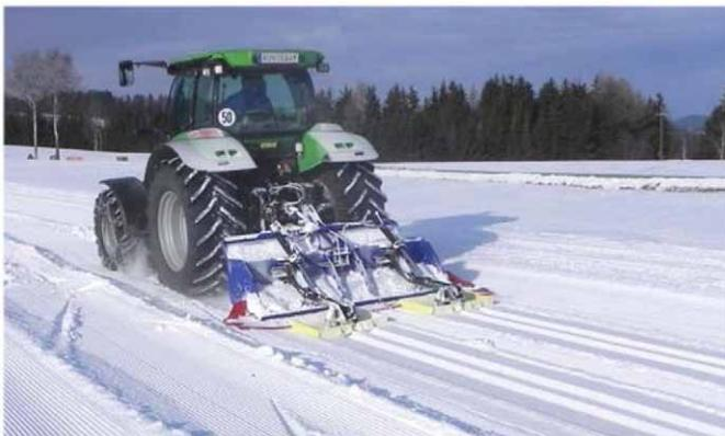
Mitte Dezember 2012 erfolgte die Bestellung eines „**Snowliners**“ und noch vor Weihnachten wurde das Gerät ausgeliefert. Es handelt sich beim Snowliner um ein an einer Traktorhydraulik aufgebautes Spurgerät, das mit einer speziellen Fräswalze den Schnee aufreißt, die Traktorspuren zudeckt, den gelockerten Schnee wieder verdichtet und mit einem Finisher die Bahn glättet. Durch zwei hydraulisch absenkbare Spurplatten werden schließlich die beiden klassischen Doppelspuren in die Loipe gepresst.
